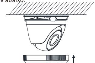
Figura 2-10 Fixação do anel de recorte na câmera
