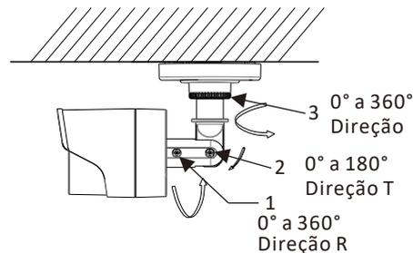
Figura 2-3 Ajuste do eixo triplo
