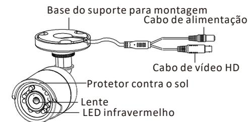
Figura 1-1 Visão geral da câmera tipo I
