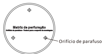
Figura 2-4. O modelo de perfuração
