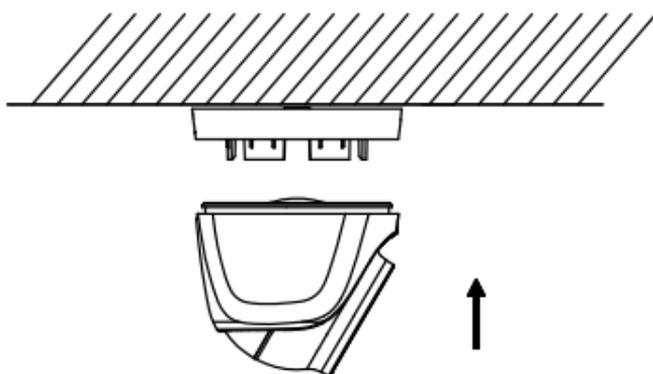
Figure 2-13 Instale a parte traseira da câmera
