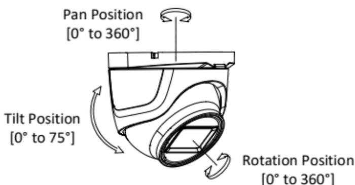
Figure 2-22 Ajuste de 3 eixos
