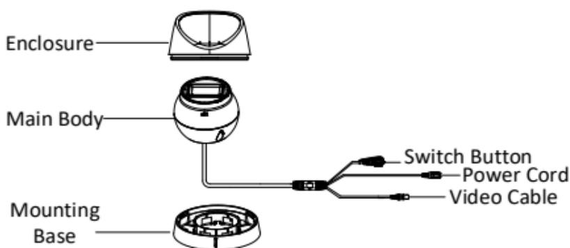
Figure 1-1 Visão geral da câmera tipo I
