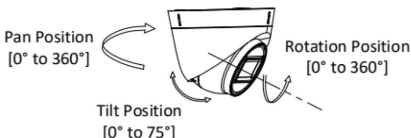
Figure 2-6 Ajuste de 3 eixos
