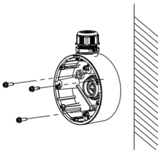
Figure 2-8 Prenda a caixa de conexão
