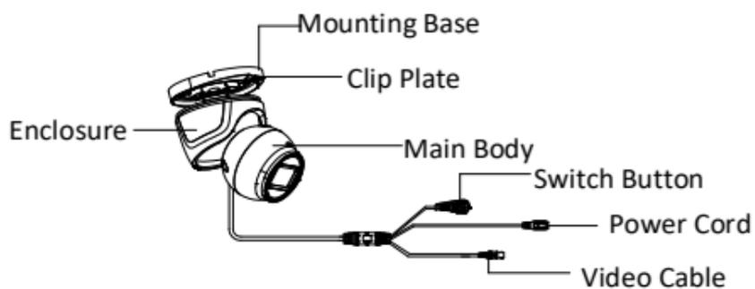
Figure 1-3 Visão geral da câmera tipo III
