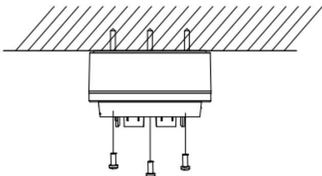
Figure 2-18 Combine a caixa de conexão
