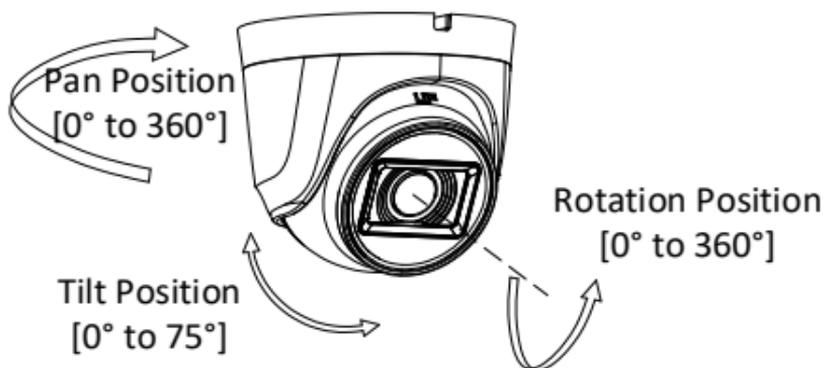
Figure 2-14 Ajuste de 3 eixos
