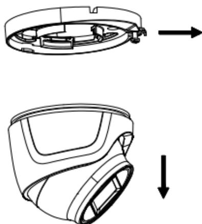
Figure 2-19 Remova a base de montagem
