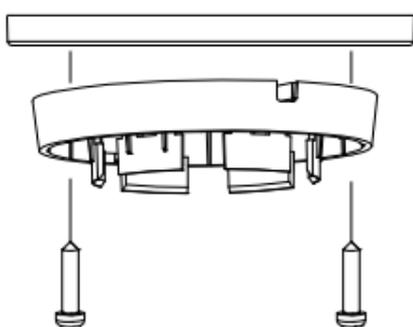
Figure 2-16 Instale a base de fixação
