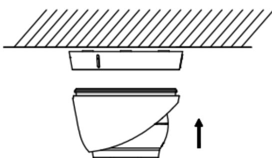
Figure 2-5 Instale a parte traseira da câmera
