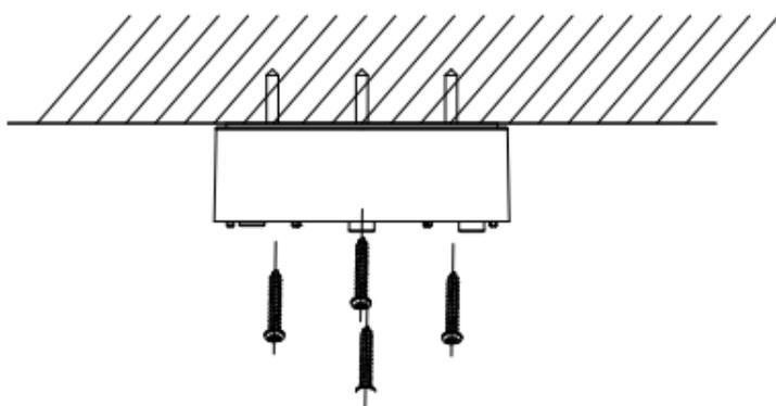
Figure 2-17 Prenda o corpo da caixa de conexão
