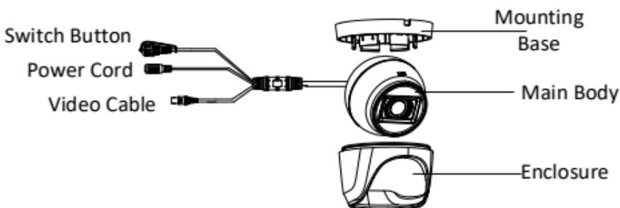
Figure 1-2 Visão geral da câmera tipo II
