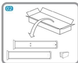
**02** Com a caixa aberta, retire os pilares laterais e a caixa de acessórios do portal conforme indicado na figura acima;
