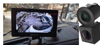
Câmera Fisheye específica e com monitor LCD incorporado, oferecem visualização lateral para impedir pontos cegos no monitoramento de veículos.
