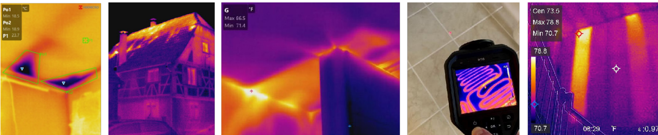
Vazamentos de água Perda de calor Vazamentos de ar Piso radiante Áreas de isolamento ausente
