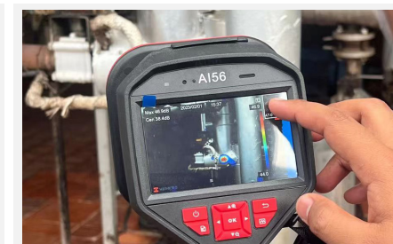
Detecção de vazamento de gás
