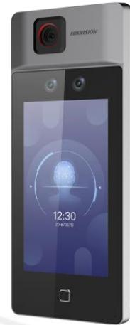
O terminal de reconhecimento facial DS-K1T671TM-3XF é uma espécie de dispositivo de controle de acesso integrado à função de verificação de temperatura. Ele pode rapidamente verificar a temperatura corporal e enviar um evento de temperatura anormal para a central. Pode ser amplamente aplicado em vários cenários, como empresas, estações, residências, fábricas, escolas, campus e assim por diante. Sistema com menu de configuração e operação em língua portuguesa.
