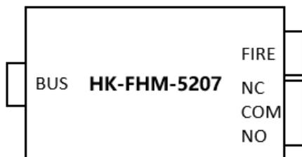
BUS：接防火门主机信号线；
