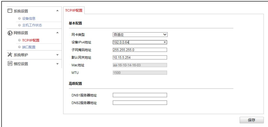
图6-4 TCP/IP 配置界面
