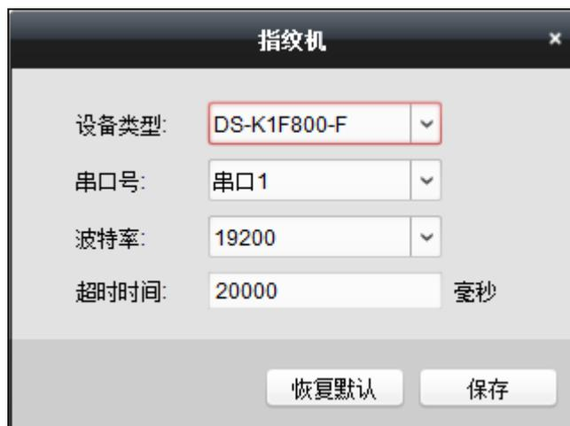
图7-41 指纹机配置窗口
