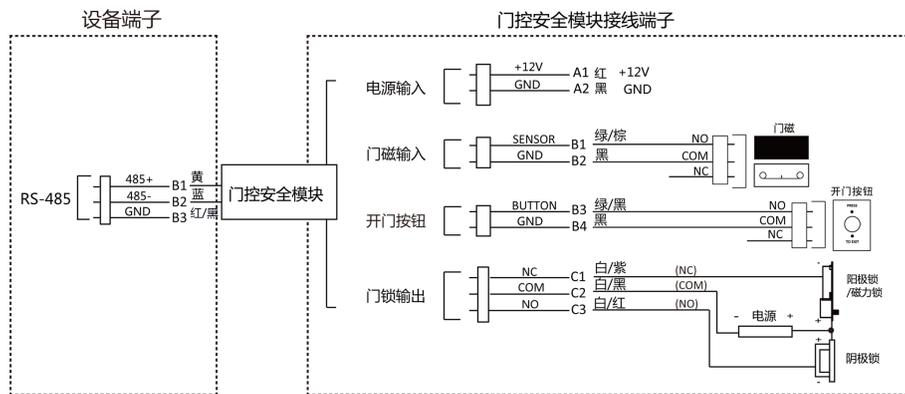
图 4-3 外接门控安全模块示意图
