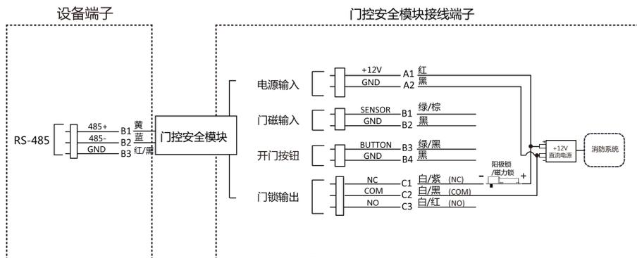
图 4-5 外接门控安全模块示意图
