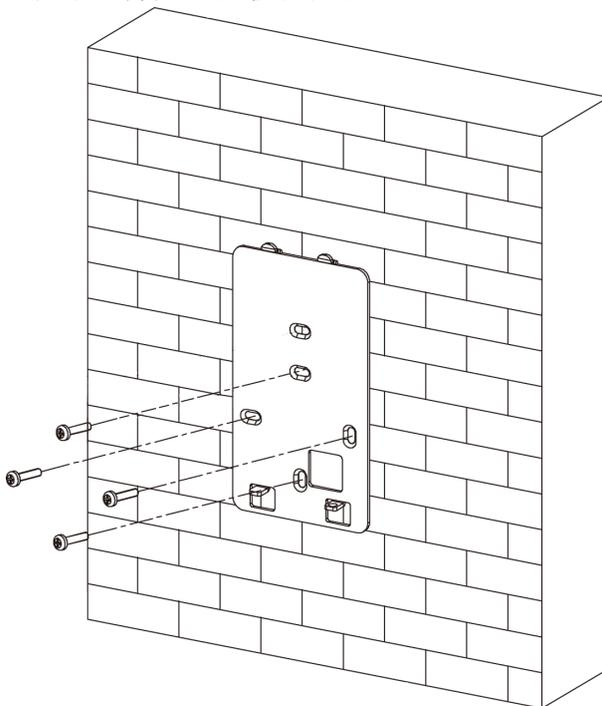
图 3-2 固定安装挂板
