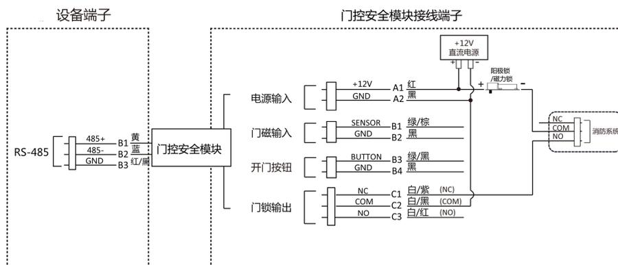
图 4-7 外接门控安全模块示意图
