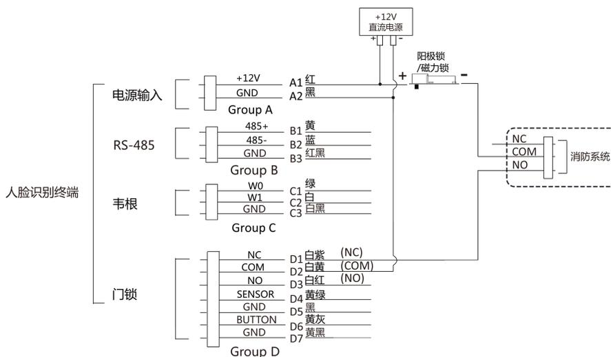
图 4-6 外接设备示意图
