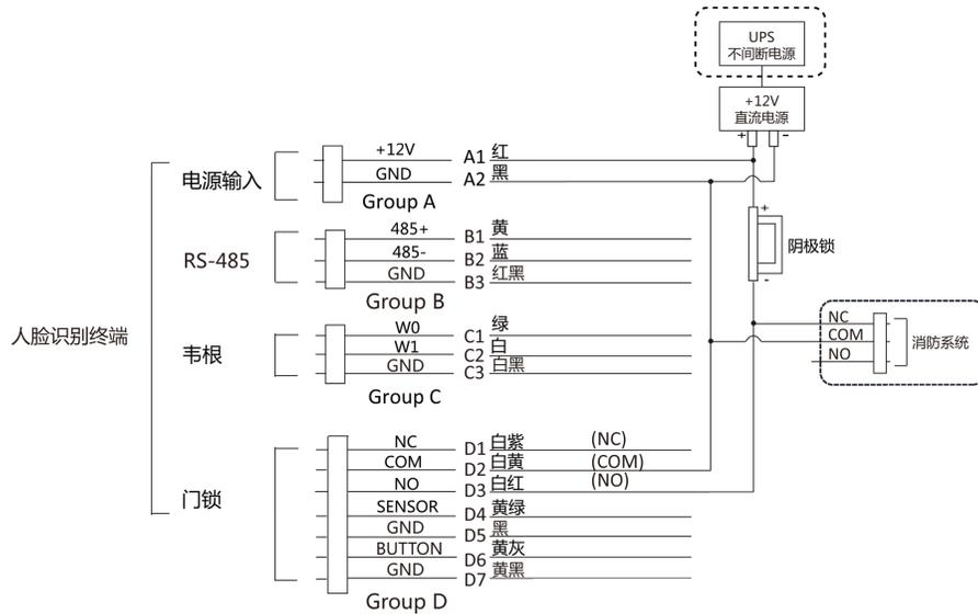
图 4-8 外接设备示意图
