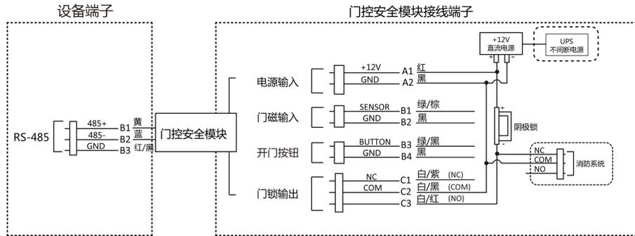
图 4-9 外接门控安全模块示意图
