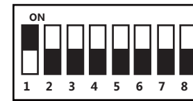
RS-485读卡器门1进拨码示意图
