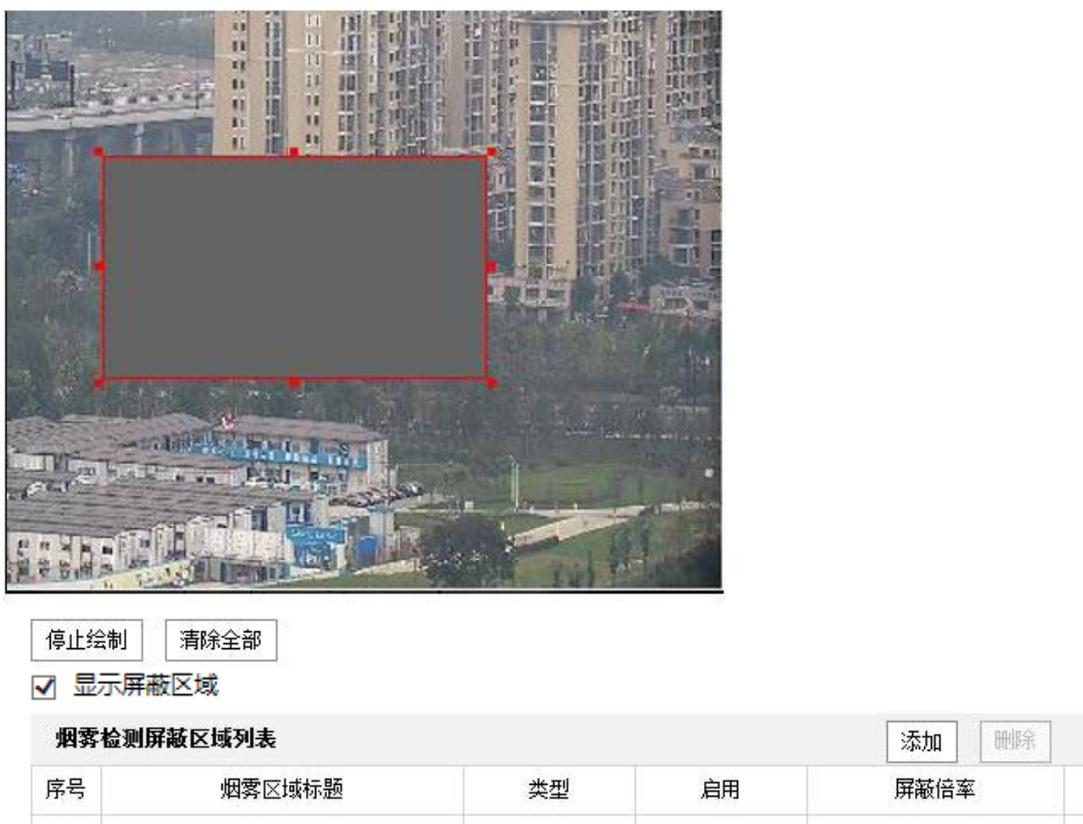
图3-25 设置烟雾检测屏蔽区域
