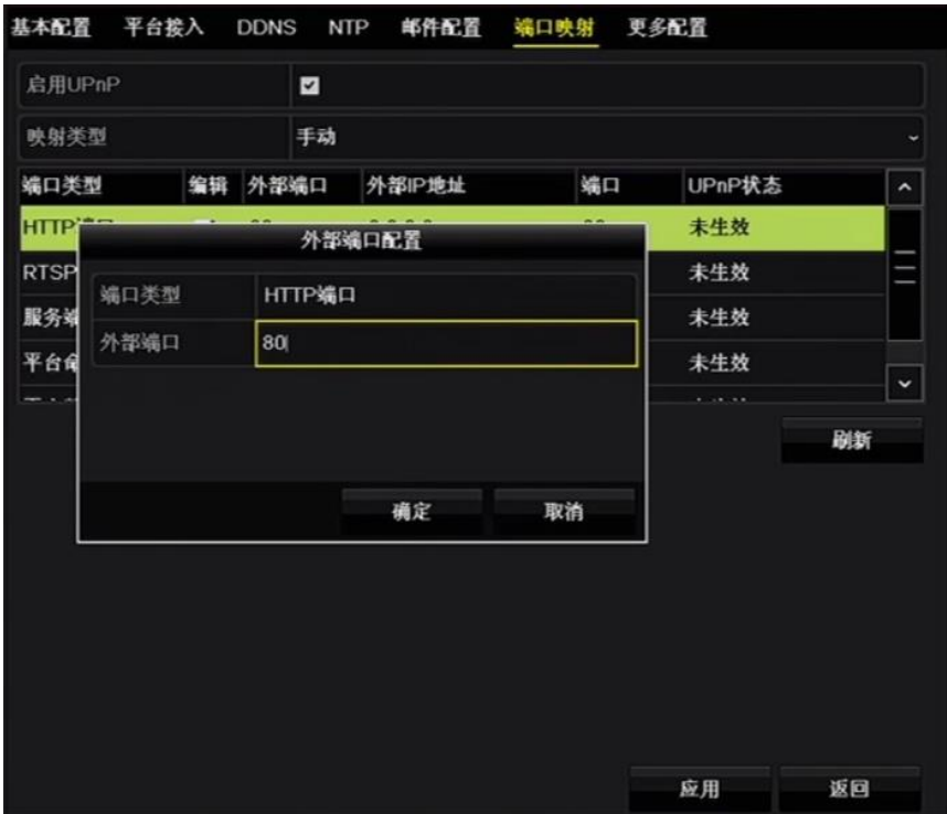
图4-180 外部端口映射
