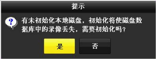
图4-196 开机检测未格式化硬盘
