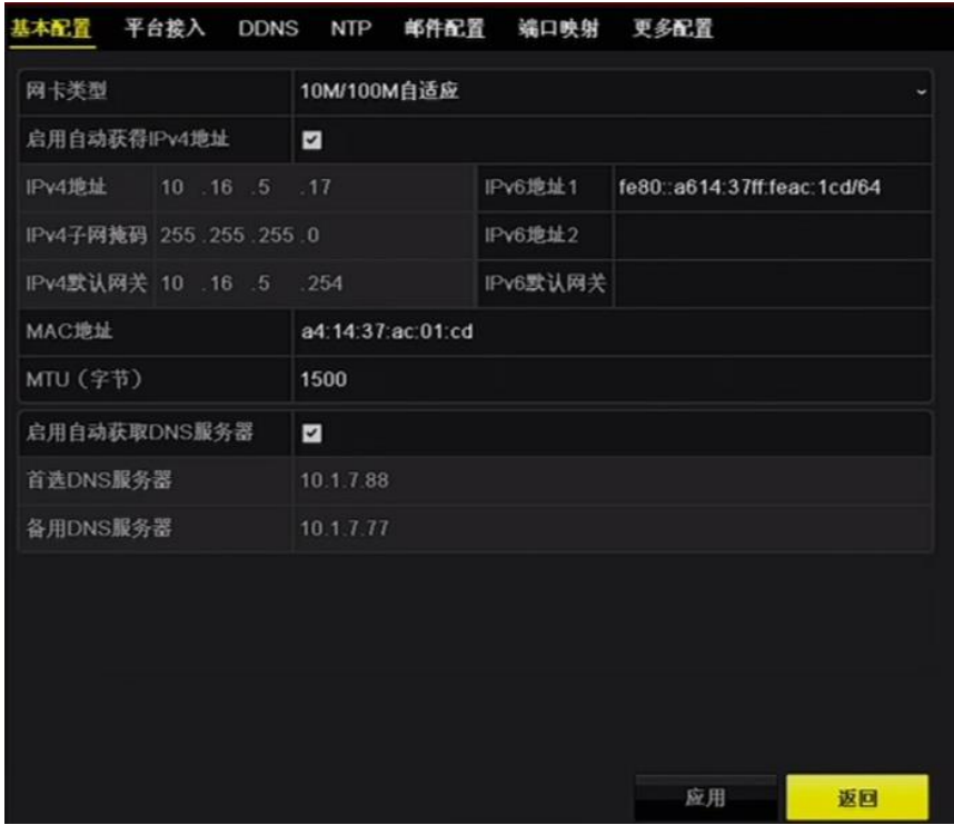
图4-171 网络配置的基本配置界面
