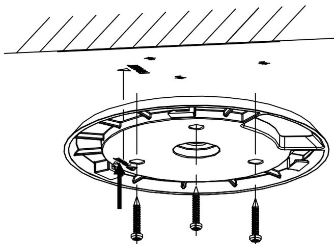
图3-6 安装吸顶盘
