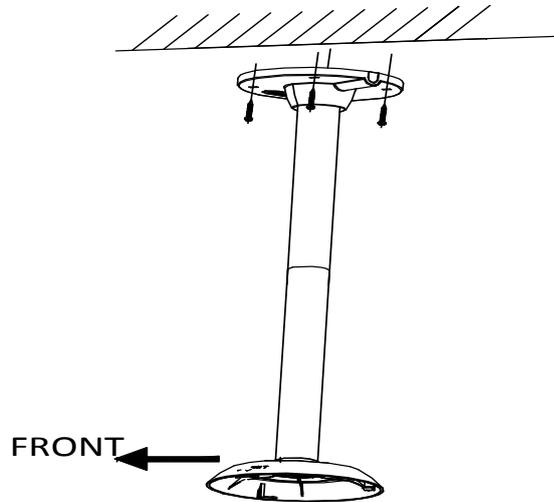
图3-16 安装吊装支架
