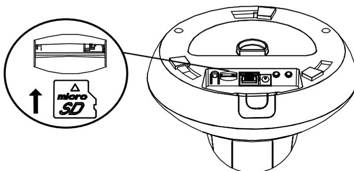
图3-2 安装 SD 卡
