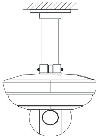
图3-30 安装摄像机
