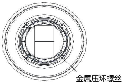
图3-32 拧下金属压环螺丝
