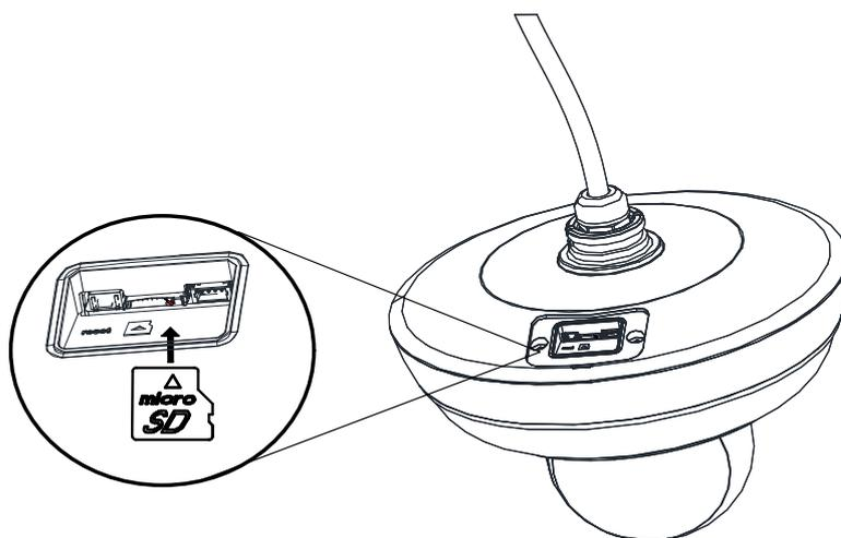
图3-4 安装 SD 卡
