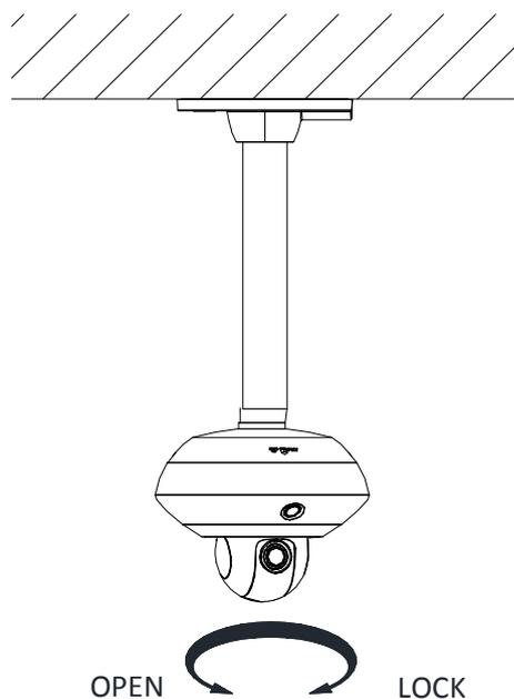
图3-18 安装摄像机
