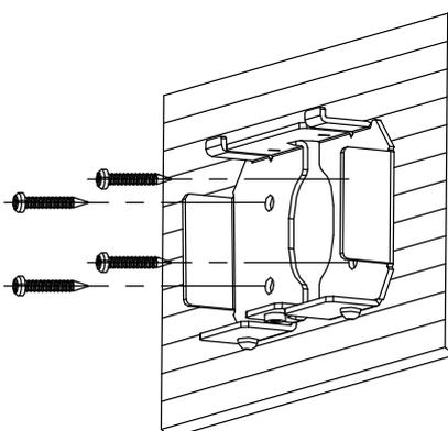
图3-12 安装固定架
