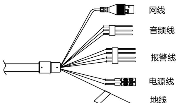
图1-4 室外全景摄像机一体化辫子线
