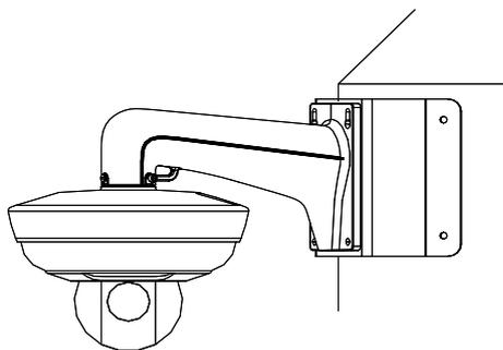
图3-25 墙角式安装
