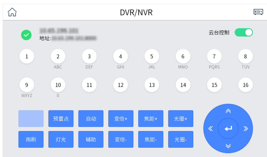
图 4-22 远程面板（开启云台控制）
