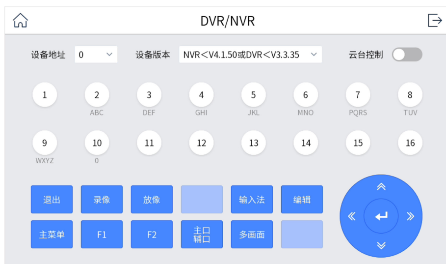
图 5-1 串口接入硬盘录像机（关闭云台控制）
