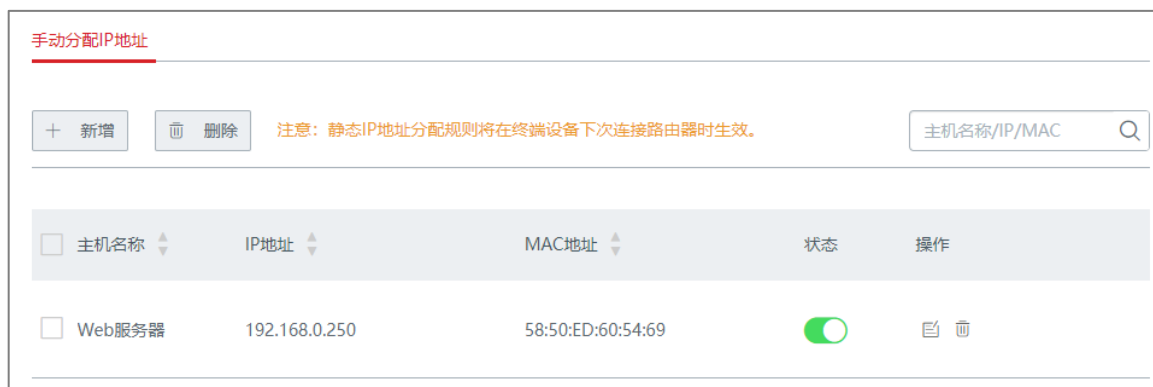
图9-35 固定 IP 地址分配完成
