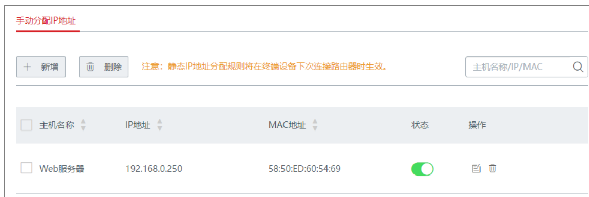
图9-25 固定 IP 地址分配完成
