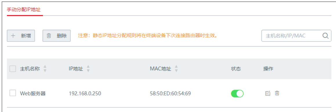
图9-41 固定 IP 地址分配完成
