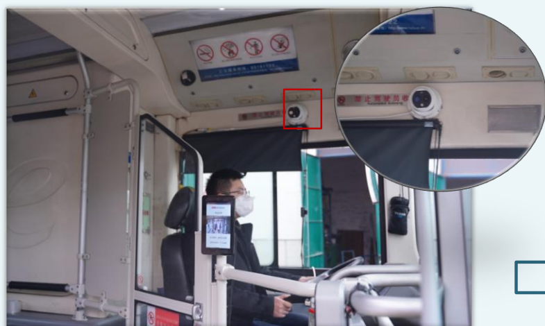
Caméra installée en haut du véhicule pour faire face à l'entrée
