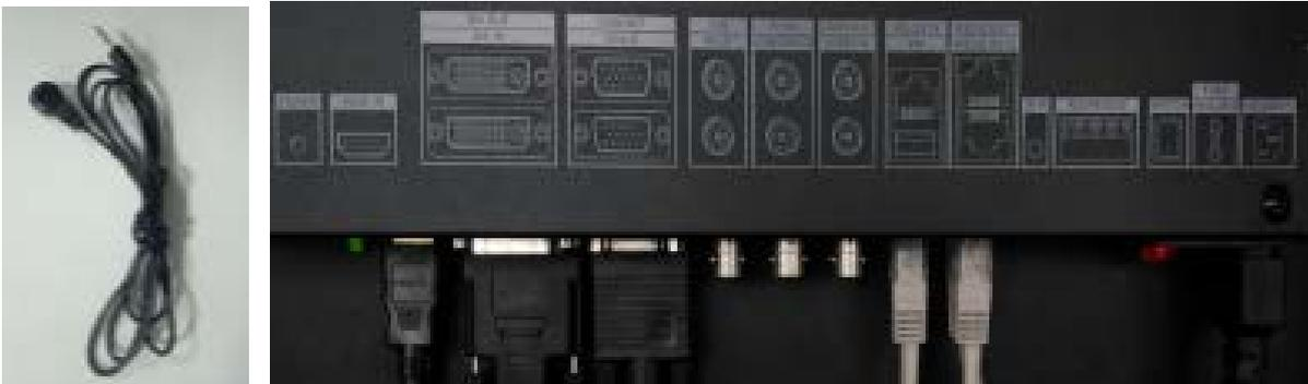
Utiliser les câbles réseau avec des interfaces RJ45, connectez le RS232 OUT1 de premier écrans sur le RS232 IN de deuxième écrans, comme le montre l'image ci-dessous
