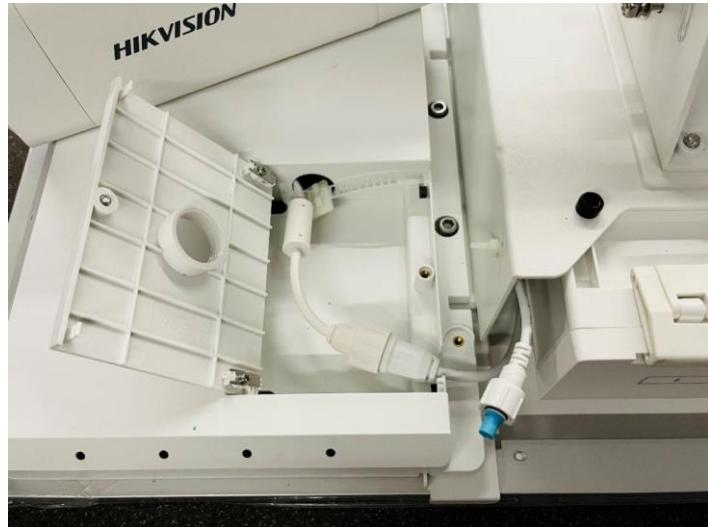
Connectez le câble RS485 au corps de la machine pour que la batterie externe alimente l'équipement.
