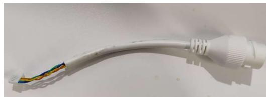
Connectez l'équipement au réseau en utilisant l'adaptateur de câble réseau.
