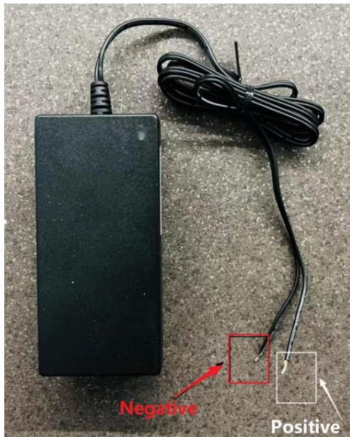
Remarques : Le fil noir pur sur le côté gauche de la séquence neutre dans la figure ci-dessus est le pôle négatif, et celui marqué en blanc est le pôle positif. Ne connectez pas les fils de manière incorrecte.
