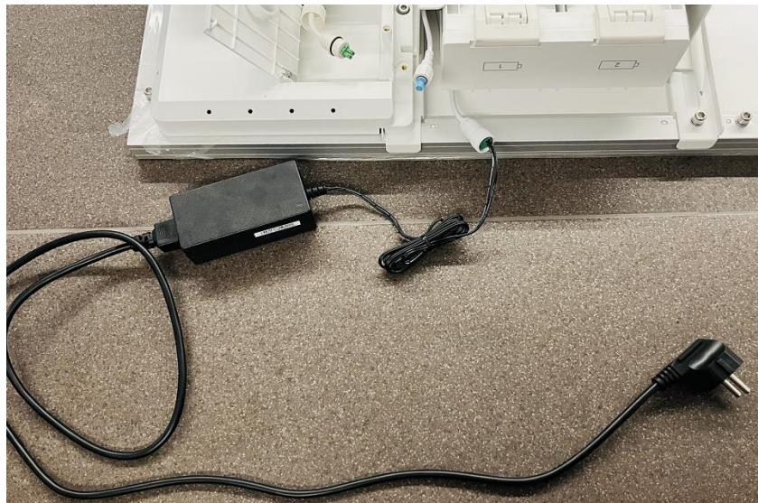
Ouvrez le couvercle de réglage du corps, tournez l'interrupteur de OFF à ON, allumez le chargeur et chargez pendant 5-6 heures jusqu'à ce que l'appareil soit complètement chargé.
