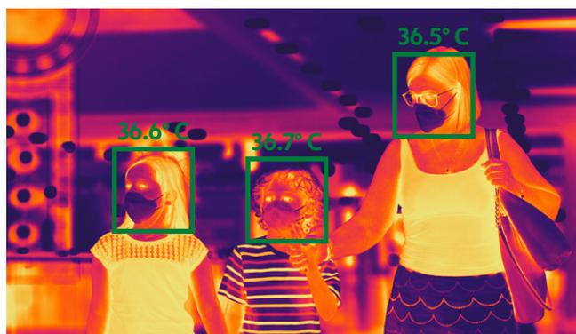
El nivel de fiabilidad de las cámaras termográficas de Hikvision oscila entre los  $\pm 0.5^{\circ}\text{C}$ , un rango suficientemente ajustado como para permitir una detección temprana eficaz. Aún y así, Hikvision completa su oferta con un calibrador de temperatura denominado Black Body, que mejora el nivel de precisión alcanzando los  $\pm 0.3^{\circ}\text{C}$ .
