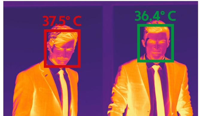
Estos terminales, que soportan varios métodos de verificación, (tarjeta, cara y temperatura), cuentan con un rango de detección de temperatura de entre 30°C a 45°C y una distancia de autenticación entre los 0,3 y los 2 metros. Todo ello, logrando alcanzar un nivel de precisión en la detección de temperatura de  $\pm 0.5$  °C, convirtiéndose en un sistema de detección preliminar de primer orden.
