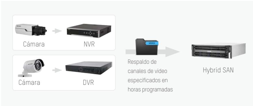
El video de alta definición puede almacenarse localmente en un NVR o DVR mediante una LAN. Cuando la red está disponible, el NVR o DVR transfiere el video al Hybrid SAN siguiendo reglas preconfiguradas. Esto crea una eficaz solución de respaldo de video bajo condiciones restringidas de transmisión de datos: por ejemplo, cuando el ancho de banda es limitado.
