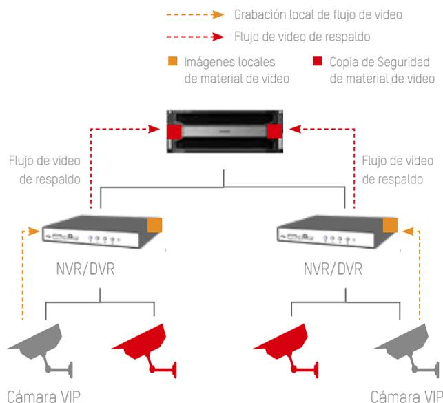
El NVR/DVR puede realizar una copia de seguridad de una grabación de una cámara VIP en tiempo real a el Blazer Pro, entonces tendrá 2 grabaciones de video de las cámaras VIP para una grabación más segura.
