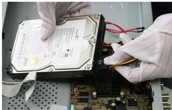
Figura 2.7 Conecte o cabo de força
