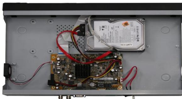
Figura 2.8 Coloque o disco rígido na base
