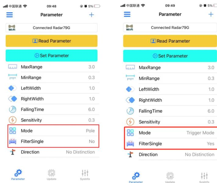
雷达检测参数回读的值全部可以设置，设置参数后需要回读检测参数来刷新程序中的数值。
