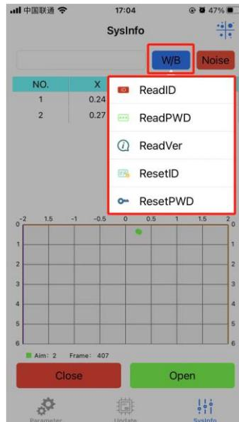
6. 雷达目标检测：安装调试时或者后期维护时，若出现误触发或者不落杆的情况，可点击“开启”，就可以将雷达实时检测到的目标以点的形式实时显示在坐标系中，方便排查。
