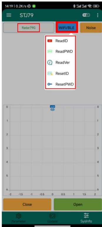
6. 雷达目标检测：安装调试时或者后期维护时，若出现误触发或者不落杆的情况，可点击“开启”，就可以将雷达实时检测到的目标以点的形式实时显示在坐标系中，方便排查。
