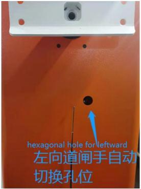
② 若杆子在开到位,顺时针转动 L 型扳手为手动挡; 若杆子在关到位,逆时针转动 L 型扳手为手动挡;
