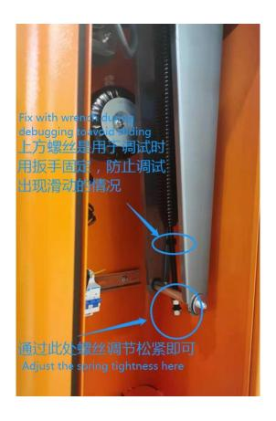
4) 杆长设置\ Pole length setting 调整弹簧符合平衡标准后,道闸上电,使道闸处于开到位状态。
