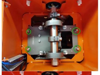
将固定道闸机芯的4个内六角螺丝卸
