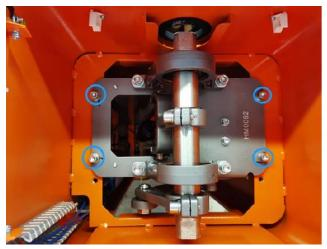
将机芯旋转180°后置入机箱,并更换另一幅 孔位固定 turn the movement 180°, and fix it with
