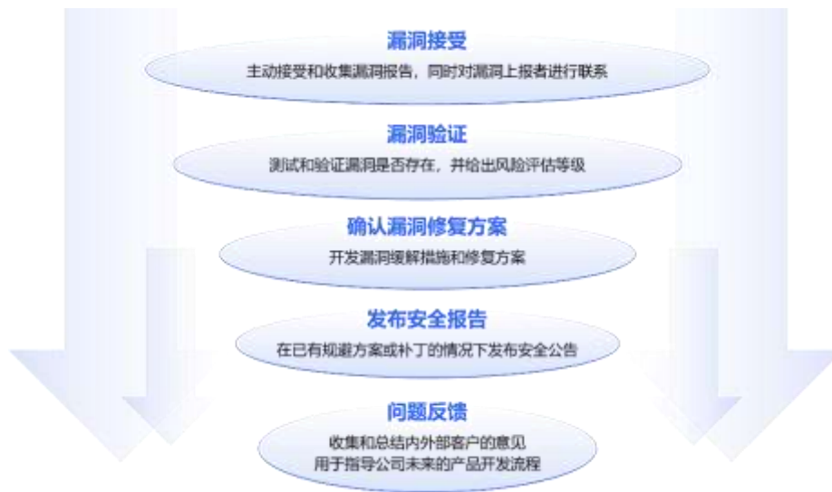
图 7-7 漏洞处理过程
