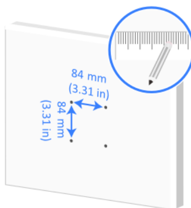
Figura 1-1 Marcação dos furos de instalação
