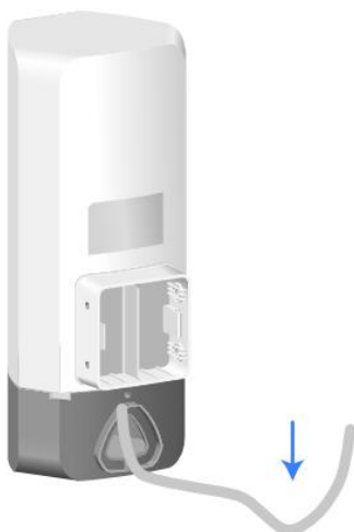
Figura 2-6 Cree Bucle de Goteo
