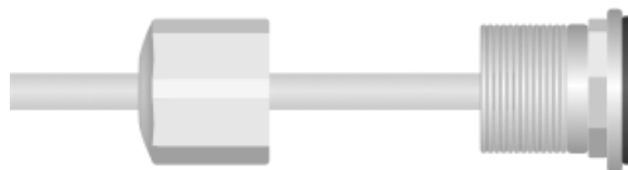
Figura 2-3 Inserte el Cable Ethernet
