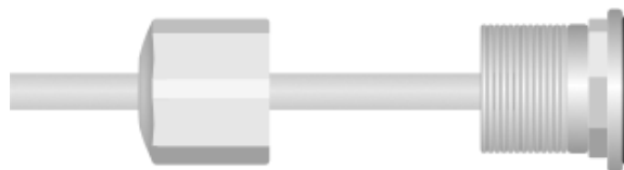
Figura 2-3 Inserção do cabo Ethernet
