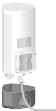
Figura 1-6 Conexão dos cabos
