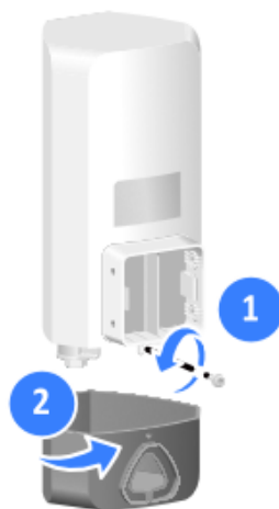
Figura 1-5 Retire el Tornillo de Fijación
