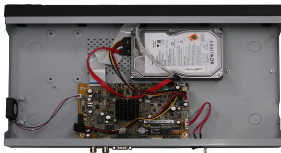
Figura 2.8 Coloque o disco rígido na base
