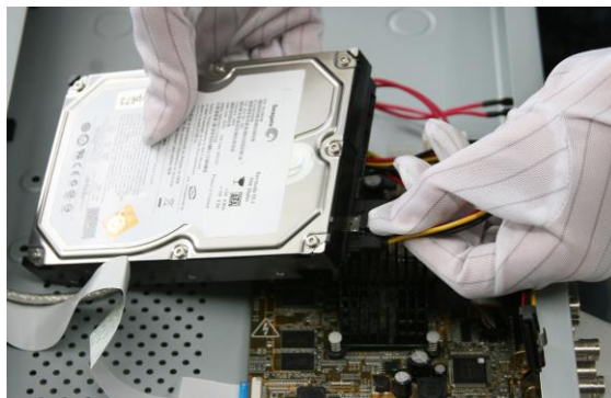
Figura 2.7 Conecte o cabo de força
