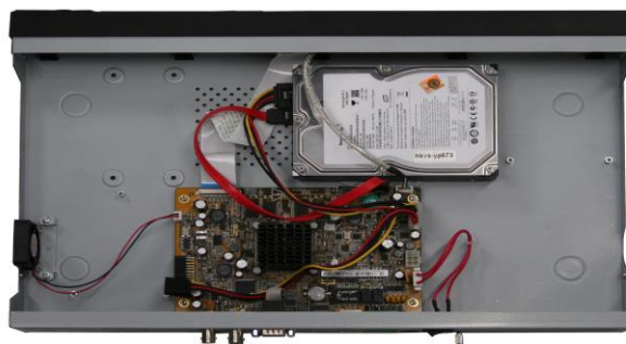
Figura 2.8 Coloque o disco rígido na base
