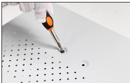
Figura 0.4 Instale o disco rígido
